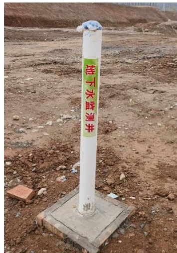
地下水监控井
